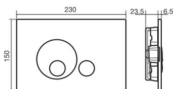
Plaque de commande mécanique
