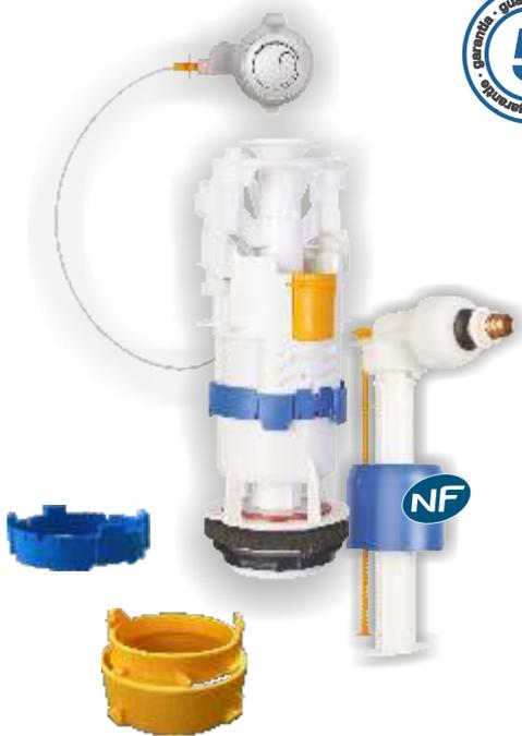
Mécanisme universel à poussoir double débit, montage simple et rapide, s'adapte à la plupart des réservoirs de 300 à 480 mm de hauteur interne rattrapage de l'axe réservoir couvercle, pas de recoupe du trop-plein, réglage télescopique, bouton chromé, fixation du couvercle possible. Passage dans couvercle : sans rosace de 38 à 45 mm, avec rosace de 16 à 60 mm.
